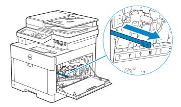
6 Insérez la tige de nettoyage dans l'un des quatre trous des languettes des cartouches à tambour jusqu'à ce qu'elle s'arrête, puis retirez-la.
