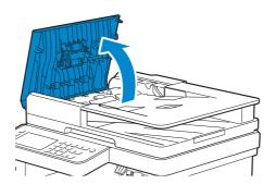
**2** Essuyez les rouleaux d'entraînement du CADRV avec un chiffon doux non pelucheux ou du papier absorbant jusqu'à ce qu'ils soient propres.
