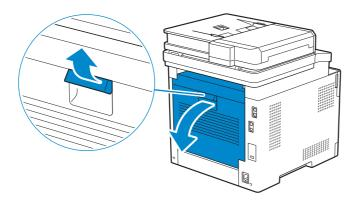
2 Tirez la languette pour ouvrir le capot de chute arrière.
