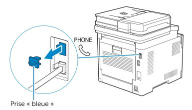
**3** Branchez le cordon de la ligne d'un téléphone ou d'un répondeur au connecteur de ligne téléphonique situé à l'arrière de l'imprimante. Branchez l'autre extrémité du cordon à un téléphone extérieur ou à un répondeur.
