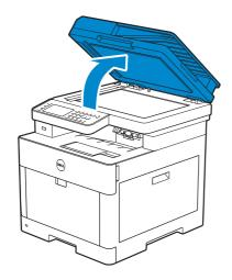
**3** Essuyez la surface de la vitre d'exposition, de la vitre du CADRV, de la bande blanche et du couvercle à document blanc jusqu'à ce qu'elle soit propre, puis à l'aide d'un chiffon sec ou de papier absorbant jusqu'à ce qu'elle soit complètement sèche.
