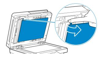
**5** Essuyez la surface de la vitre du capteur recto-verso et de la bande blanche jusqu'à ce qu'elle soit propre, puis à l'aide d'un chiffon sec ou de papier absorbant jusqu'à ce qu'elle soit complètement sèche.
