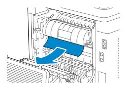
3 Tirez la languette située au-dessus du module de fusion et laissez la pièce ouverte.
