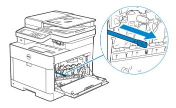
6 Insérez la tige de nettoyage dans le trou de la languette de la cartouche à tambour jusqu'à ce qu'elle arrive en butée, puis retirez-la.
